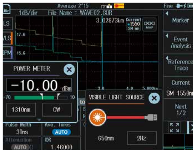
OTDR、光功率计和可见光源的多任务示例
